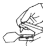
Fig.2 Glisser le bouton mâle sur le pointeau, en poussant bien à fond.
