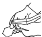
Fig.1 Positionner la plaquette dans la pince sous la languette en agissant sur le levier.
