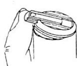
Drücken Sie den Schieber mit dem Daumen nach oben – der Stopfen lässt sich *dann* herausheben. Vor dem Verschließen schieben Sie den Schieber bis zum Anschlag hinein. Anschließend drücken Sie den Stopfen bis zum Einrasten in das Behältnis. Verschließen Sie das Behältnis nach jeder Tablettenentnahme wieder ordnungsgemäß.
