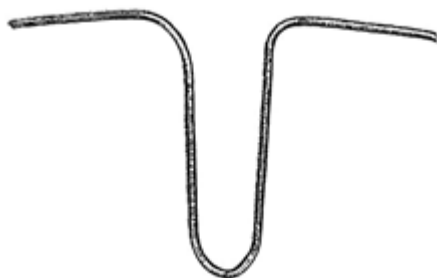
Obr. 1: Vzor háčika pre zavesenie gabonových prúžkov, mierka v skutočnej veľkosti.
