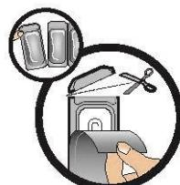
Sostenga la pipeta en posición vertical hacia arriba. Dé un ligero golpecito para asegurarse de que todo el contenido líquido se encuentra dentro del cuerpo principal de la pipeta. Doble la tira del extremo superior hacia atrás. A continuación, la pipeta se puede dejar a un lado, si es necesario. Para abrir la pipeta desprenda la parte superior por la línea discontinua.
