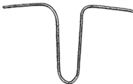
Obr. 1: Vzor háčku pro zavěšení gabonových proužků, měřítko ve skutečné velikosti
