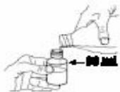
bis zur Markierung (30 ml), mit Leitungswasser auffüllen,
