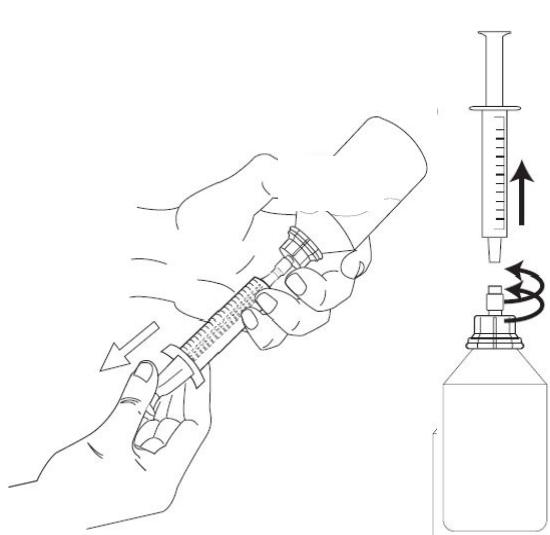
Repositionner le flacon dans sa position verticale et sortir la seringue de l'adaptateur en plastique en la bougeant doucement.
