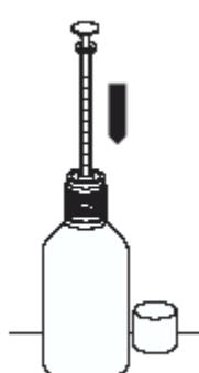
2. Prenez la seringue avec le piston complètement abaissé et insérez l'embout dans l'ouverture du bouchon. Pousser fermement vers le bas.
